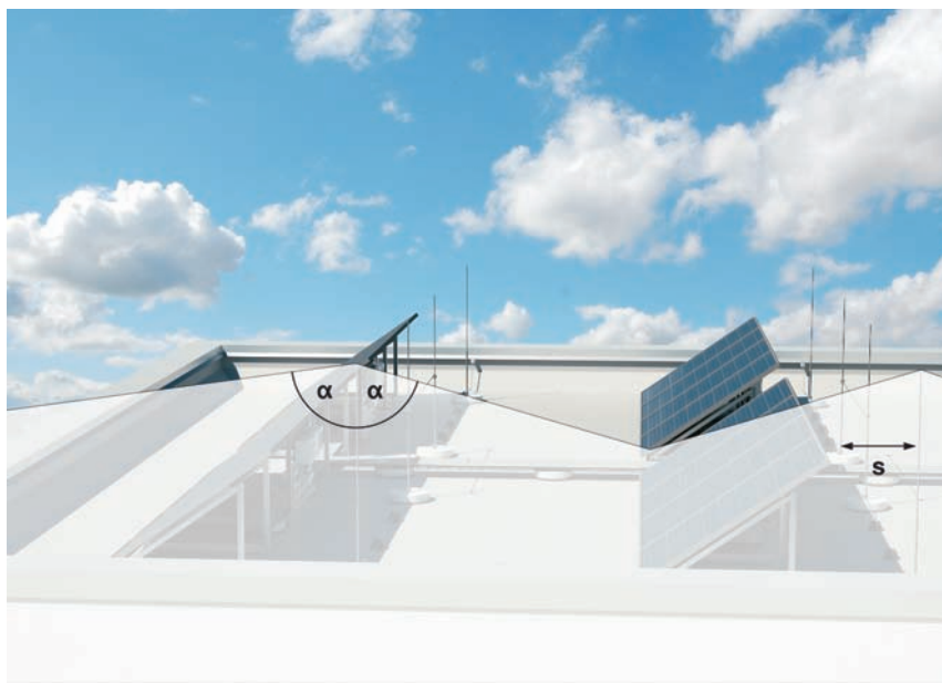
\alpha^\circ = úhel ochrany před bleskem, s = oddělovací vzdálenost
