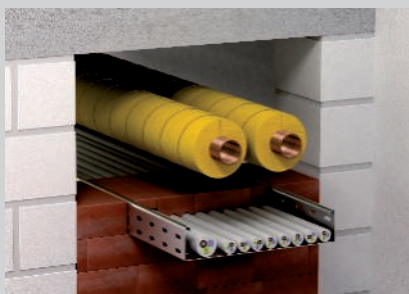
Protážené nehořlavé trubky s izolací trasy.
