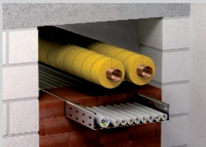
Protážené nehořlavé trubky s izolací trasy.
